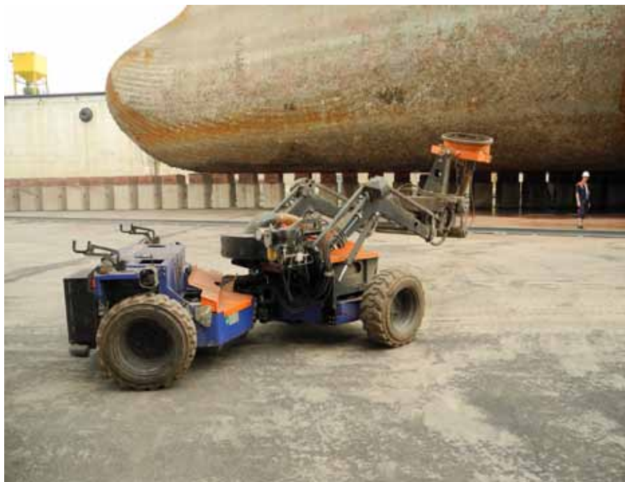
Der Behandlung der Schiffsunterseite dient der ebenfalls von Palfinger systems entwickelte HTC-BT (Bottom Treatment).
